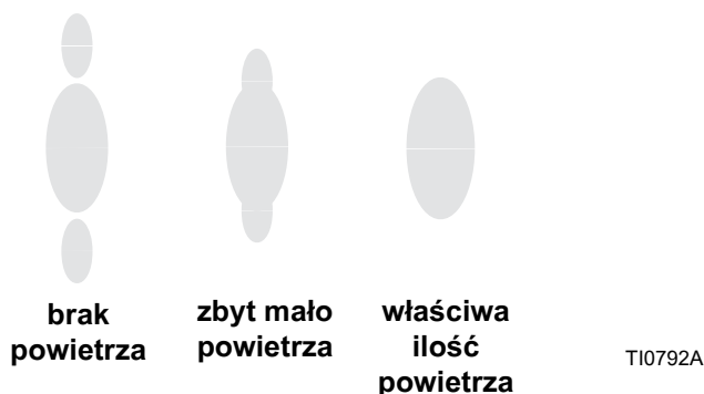
Rys. 6. Problemy związane ze wzorem natryskiwania
